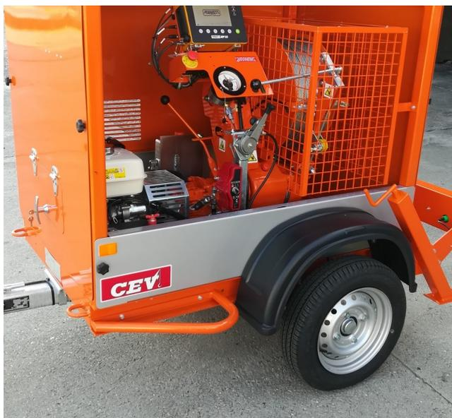
(Modèle présenté avec dynamomètre + enregistreur)
