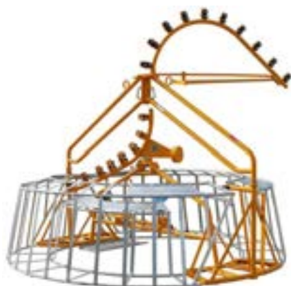
Figaro Système de stockage intermédiaire de câble évitant les figures en 8
